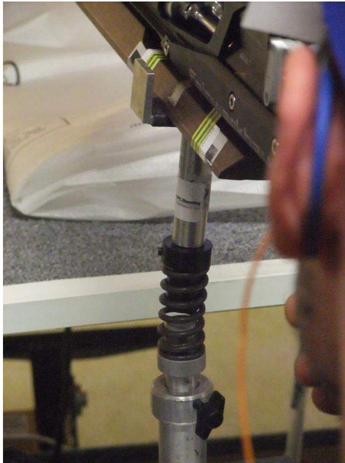
Federbock mit harter Feder ermöglicht einen Spielraum von 25mm
