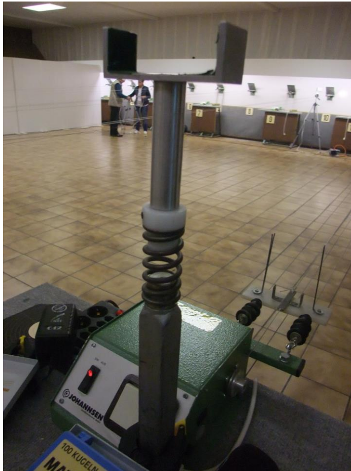
Federbock mit weicher Feder ermöglicht einen Spielraum vom 35mm
